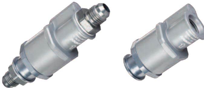
Das ROV-GA ist ein Tank Be- und Entlüftungsventil mit integriertem Überdruckventil, welches bei vollständig gefülltem Tank, bei Überschlag des Fahrzeugs, sowie bei auftretenden Fliehkräften schließt.
